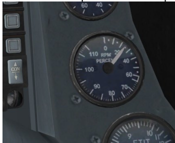
Visualisation RPM. Ici, la vitesse de rotation maximum lancée par le JFS.
