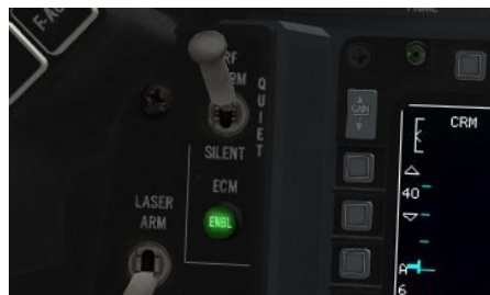
Le voyant ECM s'éclaire en vert (ENBL) pour signaler que le brouillage électronique est en fonction.
