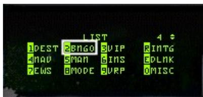
Pour éviter de quitter l'avion de ravitaillement des yeux pendant la procédure d'approche, activez immédiatement le DED sur l'option BINGO FUEL. Cet affichage permet de voir la quantité totale de carburant à bord de votre appareil. Sélectionnez le bouton **LIST** du ICP puis l'option **2 BNGO**
