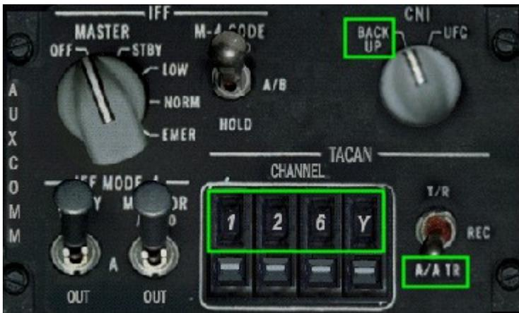
Sélectionner le mode UFC ou BACK-UP et indiquez le canal TACAN du Tanker.
