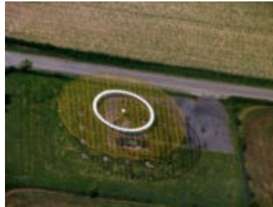
Vue aérienne d'un ensemble d'antenne d'une balise VOR de Sprimont "SPI" en Belgique
