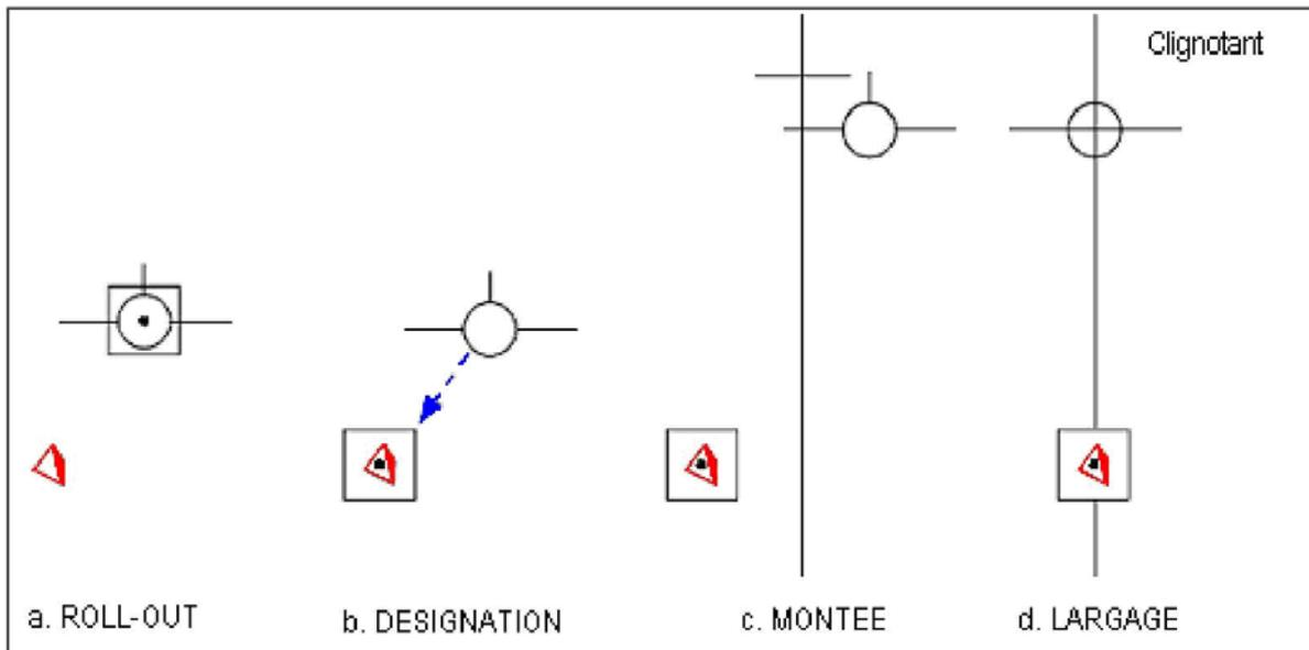
Le repère horizontal de solution descend, maintenir le FPM sur la steering line jusqu'au tir automatique. Si vous négligez l'erreur d'azimut en visée en déplacement et que le repère de solution approche du centre du FPM, vous avez 3 options :
