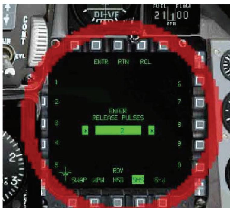
Viennent ensuite les réglages permettant d'intégrer dans le calculateur le WPT 5 comme étant la cible et ainsi d'effectuer le bombardement en CCRP. Ceci offre l'avantage de pouvoir bombarder précisément à une altitude saine et indépendamment du plafond ou de la visibilité.
