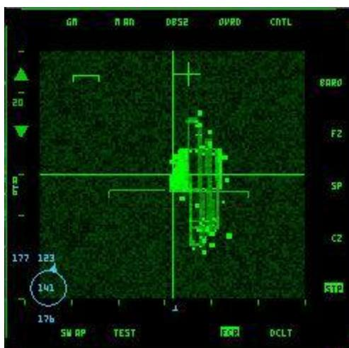
En diminuant la portée du radar, et du fait de notre rapprochement à la cible, on distingue de plus en plus de détails, notamment les deux pistes, les taxiways, ainsi que des éléments fixes qui peuvent être aussi bien des petites structures que des batteries de défense aérienne.
