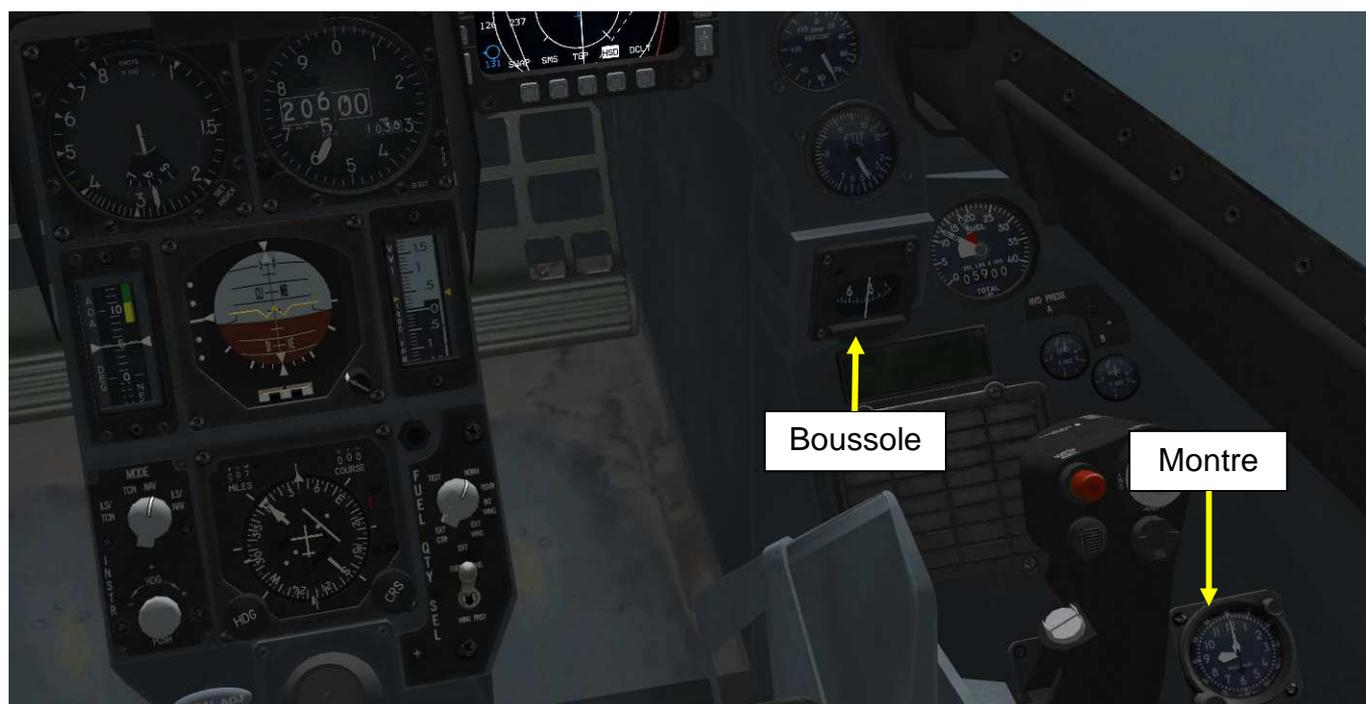
C'est 2 instruments permettent une navigation à la montre et boussole couplée au tachymètre.
