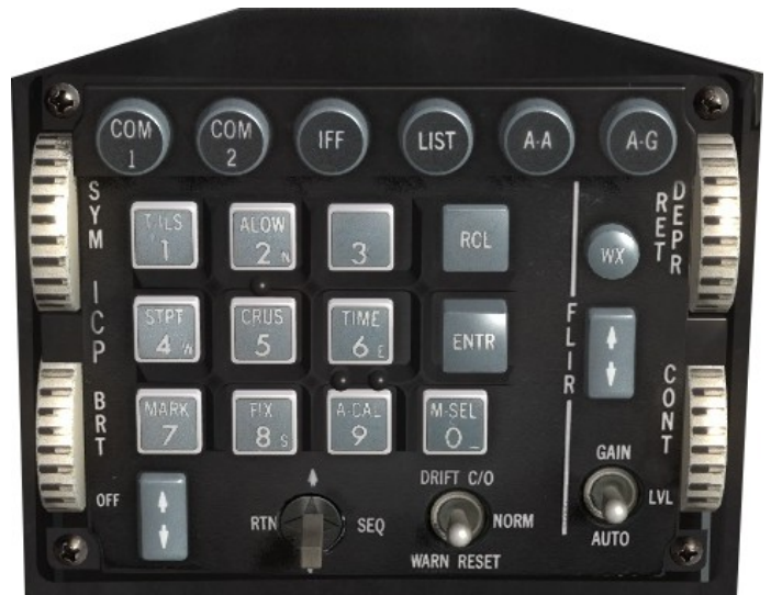
Appuyer sur le bouton RTN (return) du DCS pour revenir à l'écran initial du DED.
