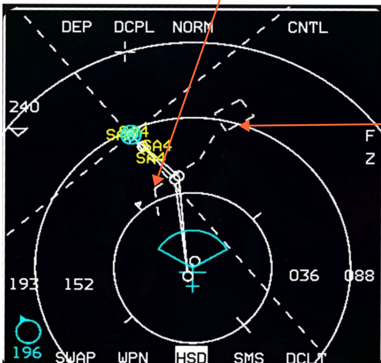
Exemple de lignes de marquage apparaissant sur la VTH(HUD)
