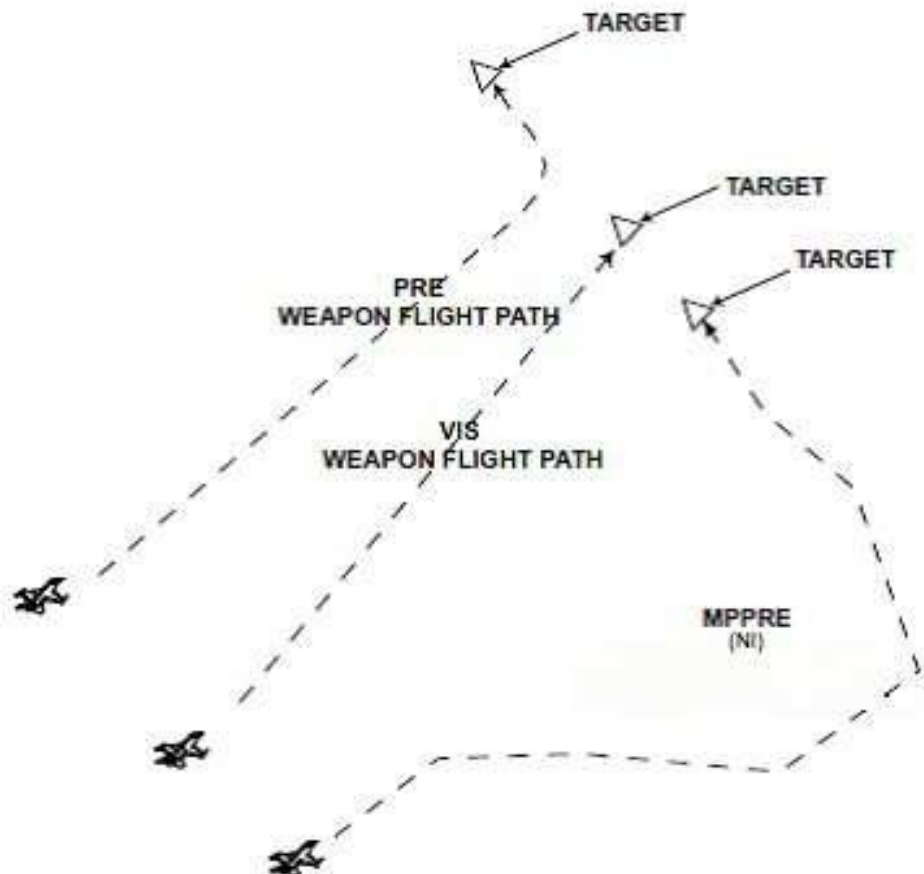
Figure 85 Les profils de lancement typiques des plans de vol des sous-modes IAM
